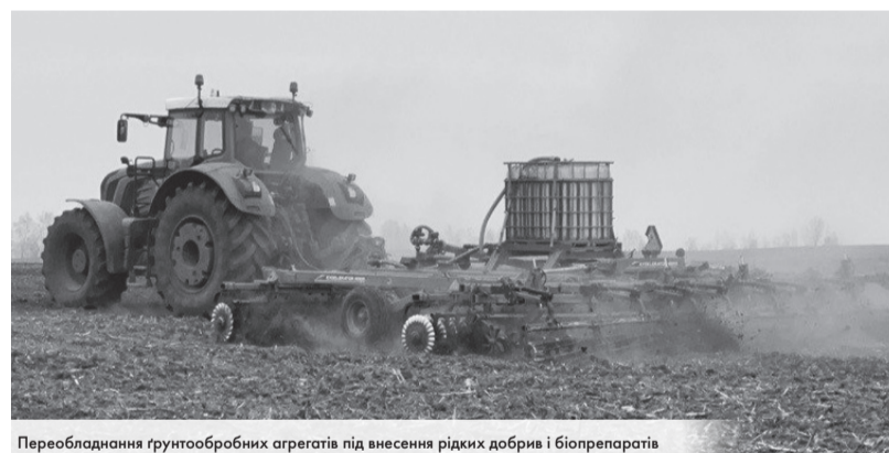
Переобладнання ґрунтообробних агрегатів під внесення рідких добрив і біопрепаратів
